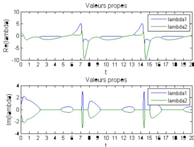
Variation importante de la valeur propre réelle des valeurs propres et, en particulier, de l'amplitude de la partie réelle négative
