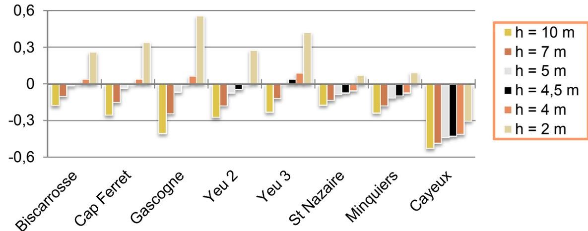
→ Statistiques (biais,  $R^2$ , erreur RMS, indice de dispersion) optimales pour les hauteurs, périodes et directions des vagues dans le Golfe de Gascogne pour  $h = 4,5$  m
